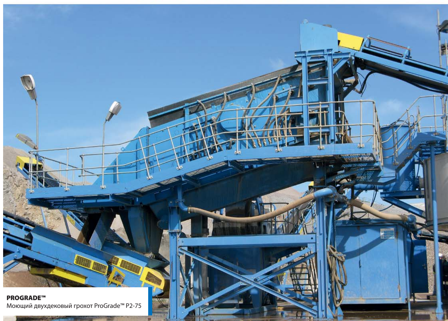
PROGRADE™ С мощного грохота ProGrade™ материал подается на корытную мойку RotoMax™
