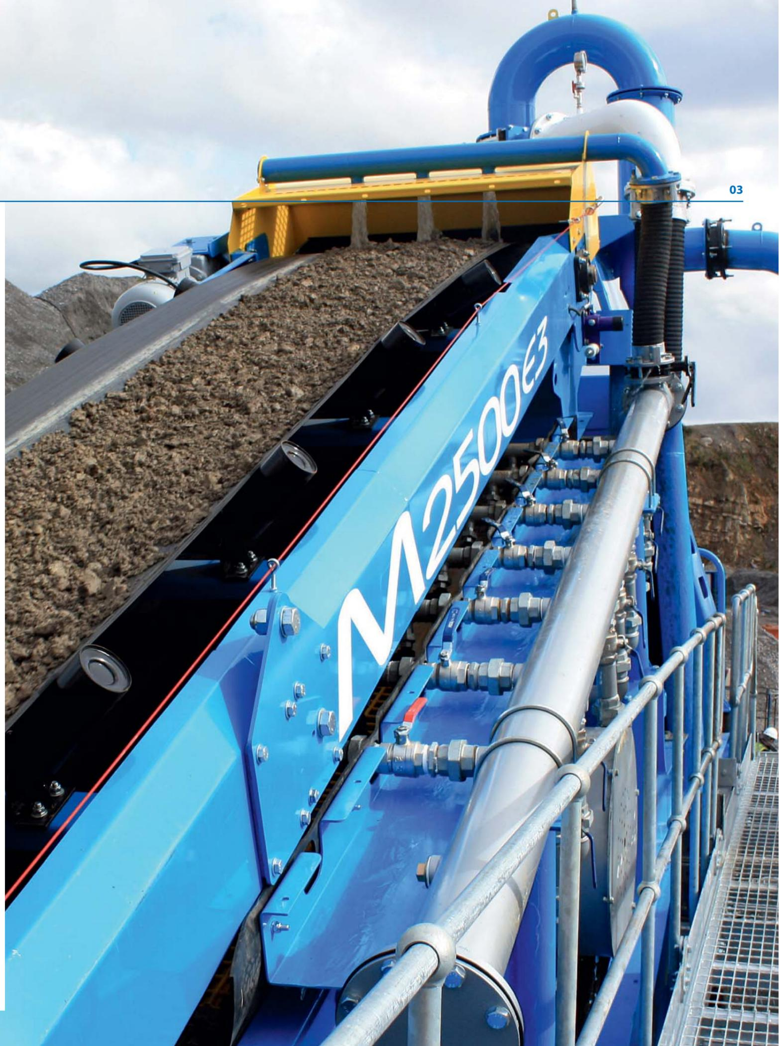
**M2500™\* представляет собой революционную мобильную установку, предназначенную для промывки, сортировки, обезвоживания и складирования щебня, гравия и песка.**
